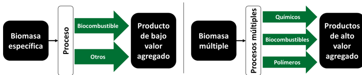
Figura 2.2. Comparación entre el enfoque de una biorefinería tradicional (izquierda) y una biorefinería integrada (derecha) (adaptado de Aresta et. al. 2012).
