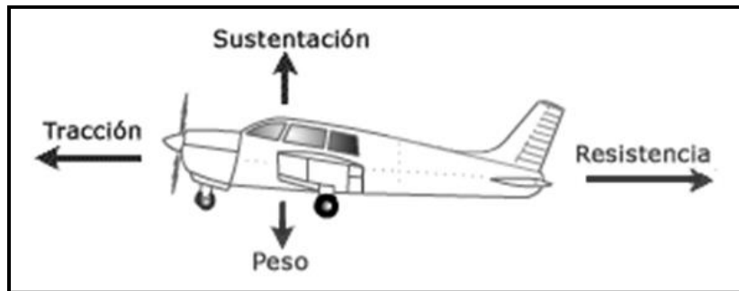
Figura 3 Fuerzas a las que se somete una aeronave [7]
