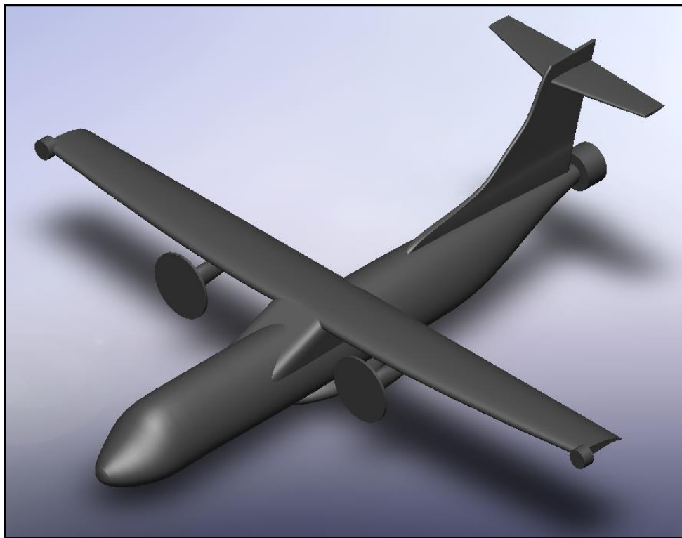
Figura 36 Geometría - propulsión en ala y fuselaje [23]
