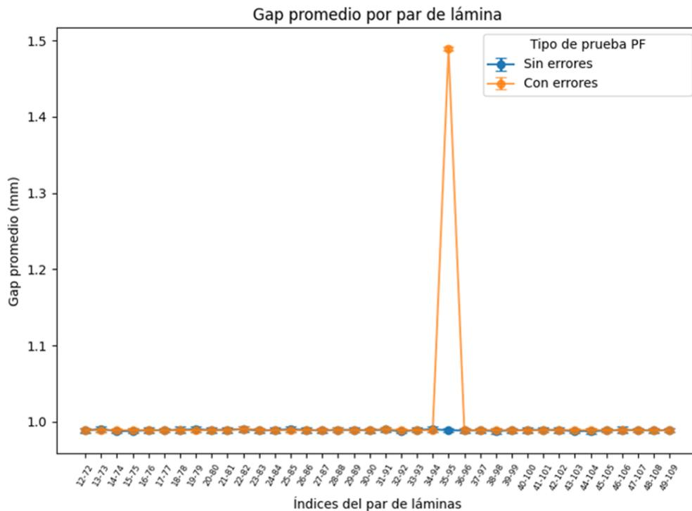
Figura 17. Gráfica del gap promedio entre pares de láminas en las dos pruebas PF. Se observa un pico correspondiente a un error del tamaño del gap en el par de láminas 25-95.
