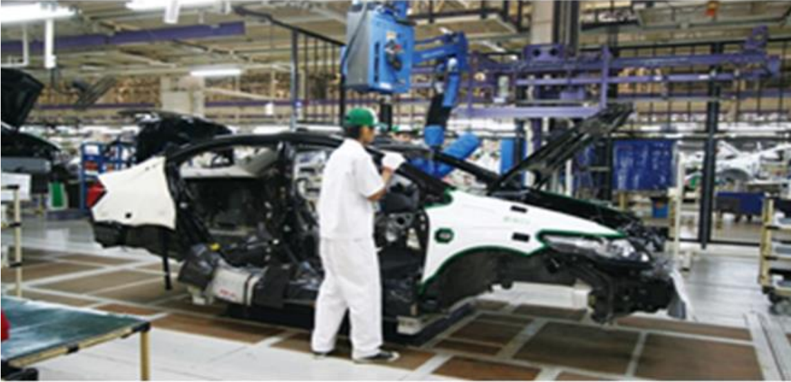
IMAGEN 3. Línea de ensamblaje en Honda Tailandia con tapetes de detección de presencia y detención automática
