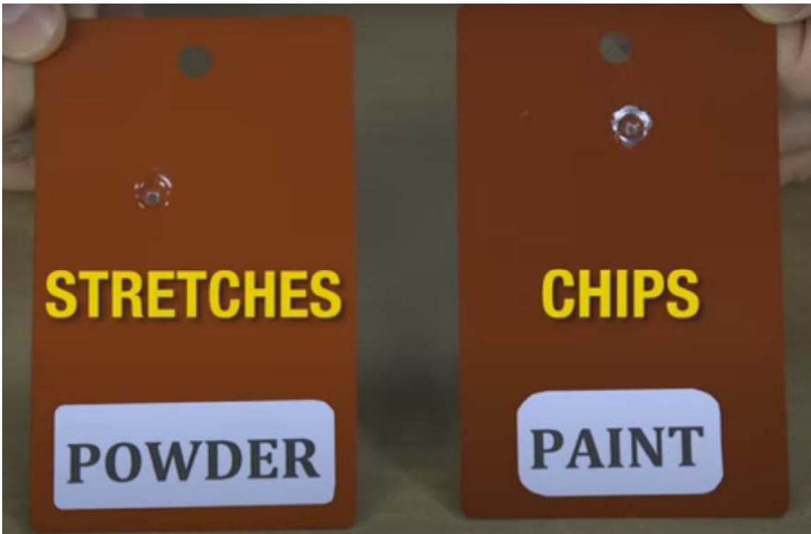
Figura 2.4 Comparación de una lámina baja un impacto.
