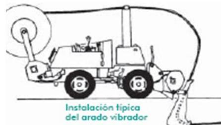
*Figura 2.4 Instalación de Cable Armado. [4]*
