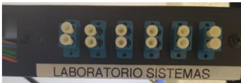
Figura 4.5 patch panel con conectores LC.
