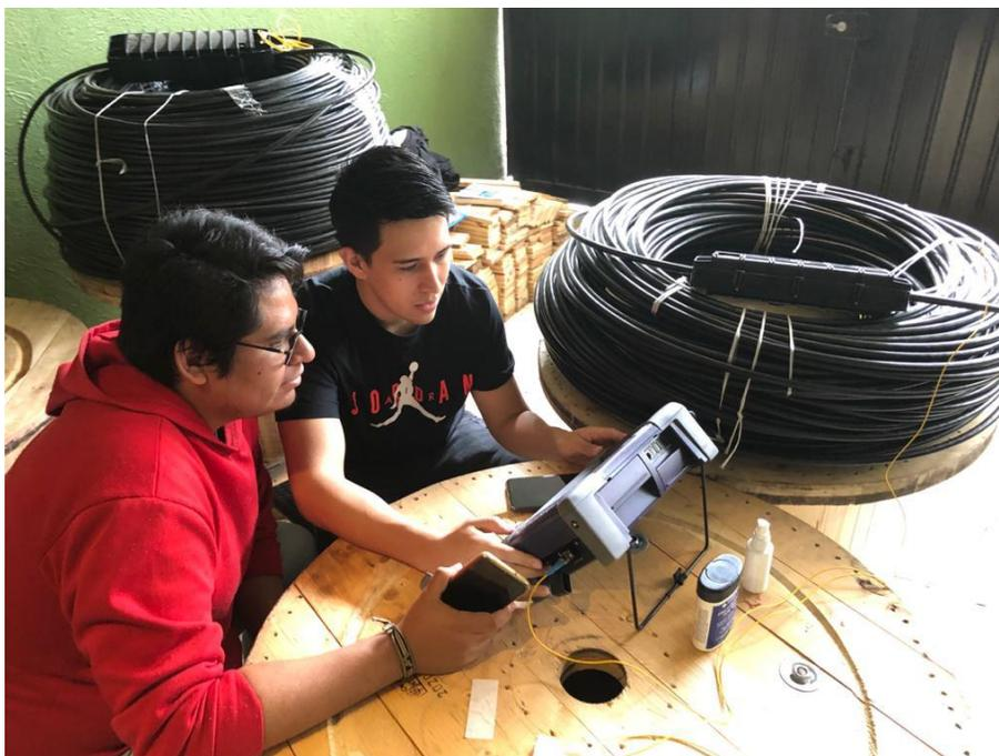
*Figura 5.12 Realizando mediciones con OTDR.*
