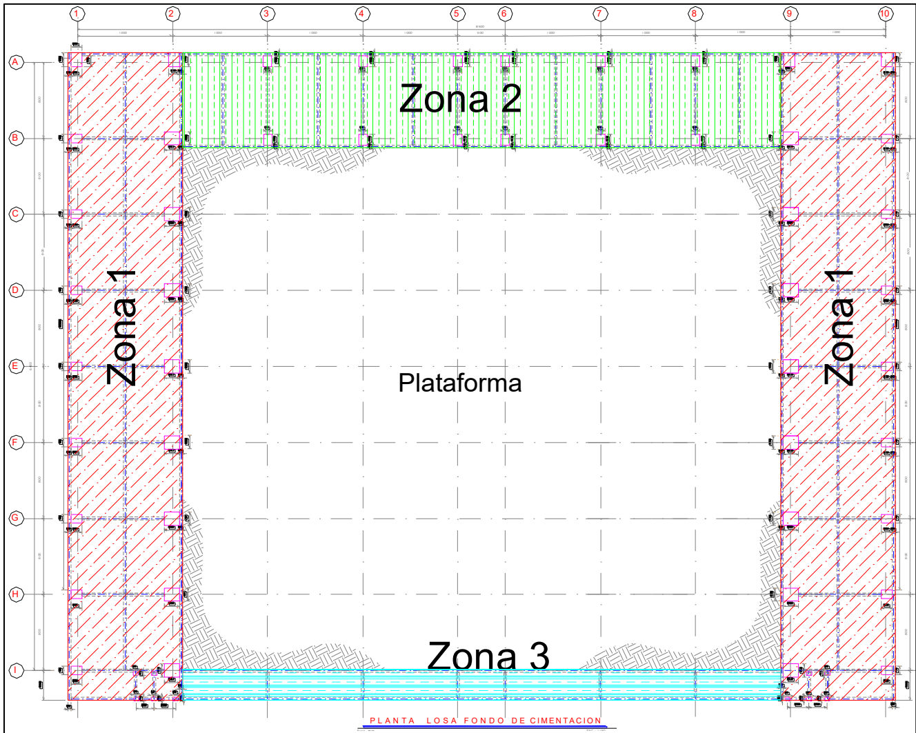
Figura 29 Planta de cimentación.
