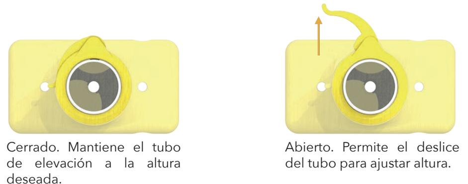
Fig. 49 Movimiento de apertura del seguro de elevación.
