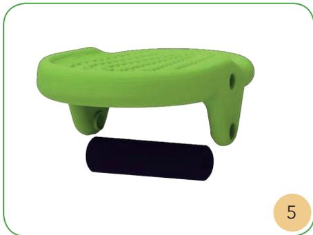
Primero se preparan los soportes. Para ello por la parte inferior del soporte se colocará el rodillo entre las orejas del soporte, coincidiendo con las perforaciones por donde entrará el eje de rodillo.
