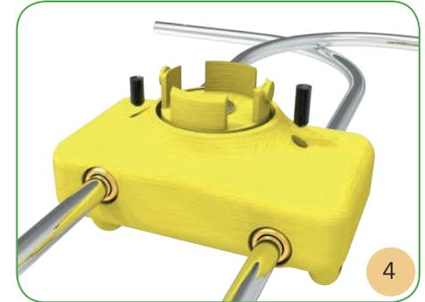
Para asegurar los bujes y evitar su giro y movimiento. Se colocará un prisionero de 3/16" x 3/8" en la perforación corta que llega al buje y un prisionero de 3/16" x 1/2" en la perforación profunda al buje.
