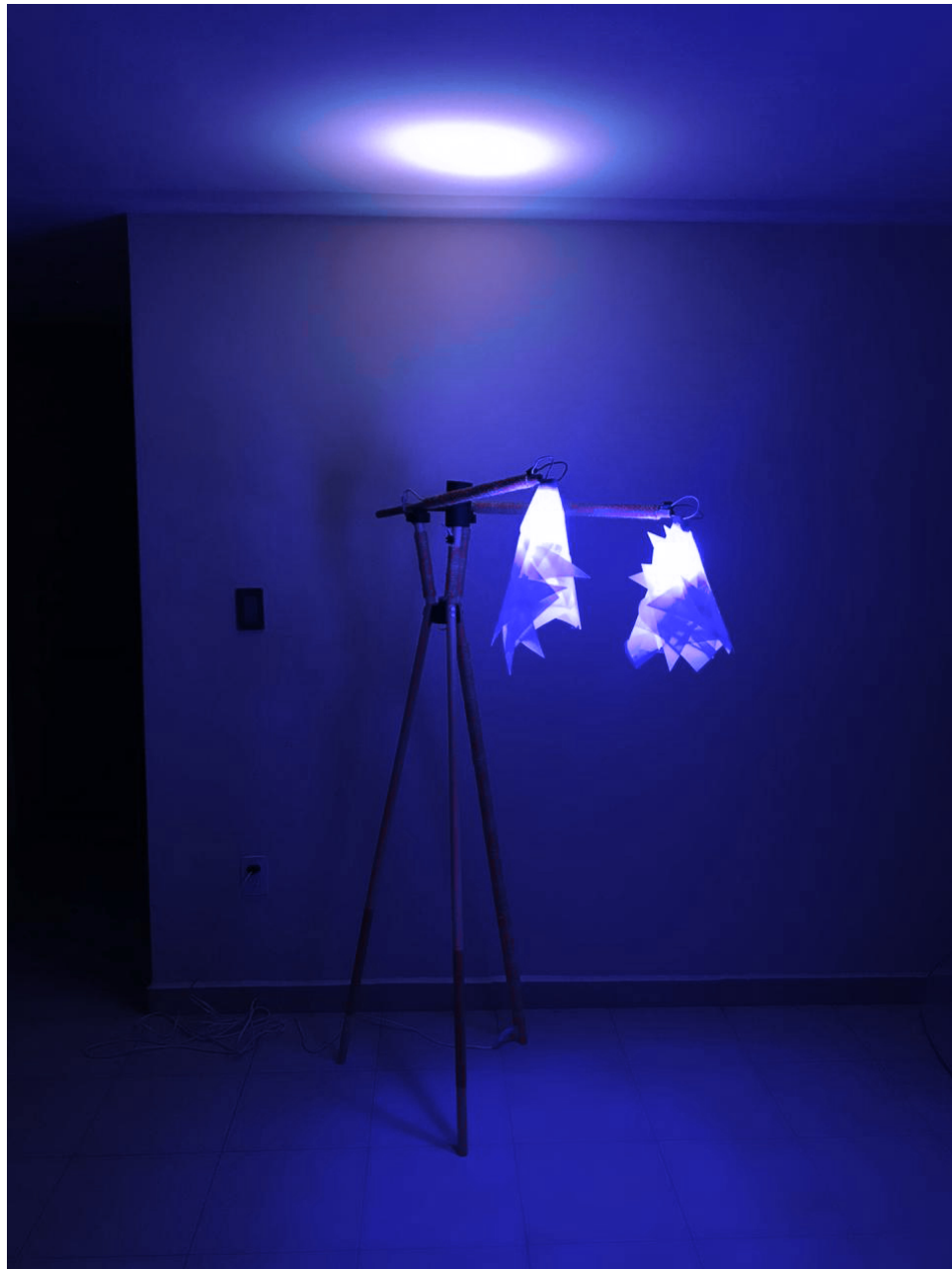
Imagen 107. Prototipo de luminaria para el control del síndrome icterico en periodo neonatal Fuente: fotografía tomada por el autor de la presente investigación
