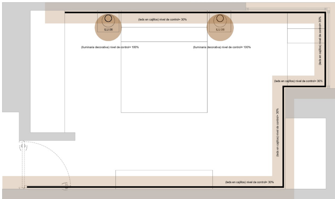
Imagen 57. Escena 2 – lámparas y nivel de control Fuente: imagen realizada por el autor de la presente investigación, con uso del programa DIALux evo 9.2
