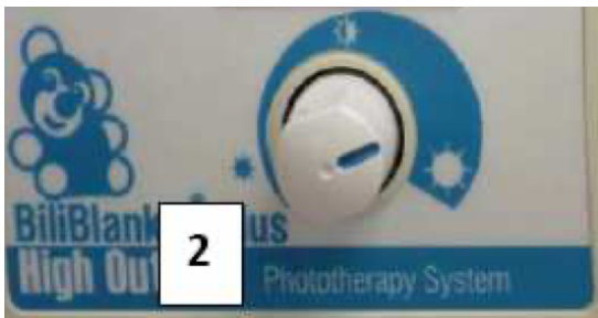
Imagen 74. Selector de intensidad de la luminaria Fuente: https://www.chospab.es/publicaciones/
