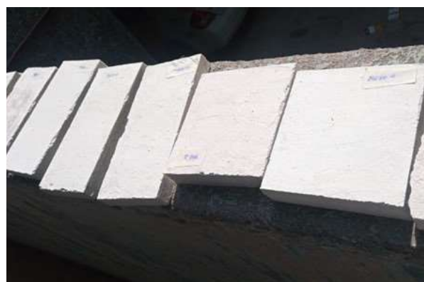
Figura 36.- Exposición de las piezas a la intemperie para determinar su humedad interna. Fotografía de elaboración propia.
