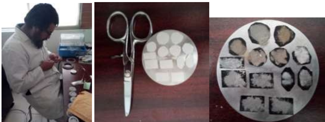
Figura 58.- Proceso de preparación de muestra para la prueba del microscopio de barrido. Fotografías de elaboración propia.
