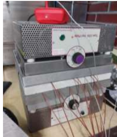
Figura 31.- Aparato con el que se realizó la prueba de placa caliente aislada en el instituto de materiales de la UNAM. Fotografía de realización propia.
