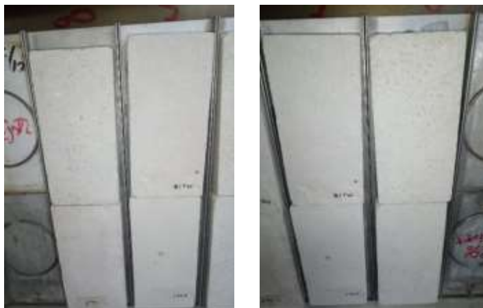
Figura 46.- Fotografías de comparación del desgaste de las muestras de ambas mezclas. Figura de elaboración propia.
