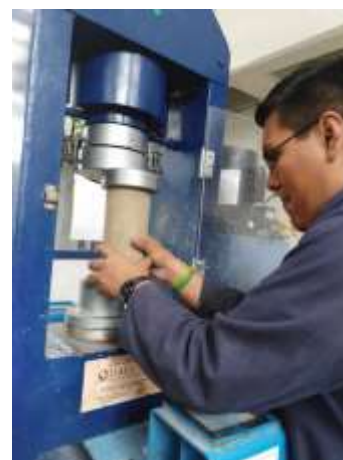
Figura 32.- Elaboración del ensayo de compresión de cilindros de concreto en el laboratorio 4 de FES Aragón. Fotografía de elaboración propia.
