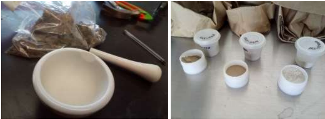
Figura 56.- Proceso de molido de muestras. Fotografía de elaboración propia.
