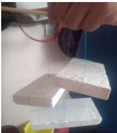
Figura 35.- Preparación de las muestras para prueba de absorción total a 24 horas. Fotografía de elaboración propia.
