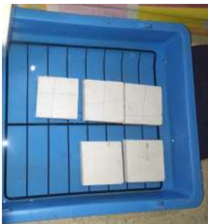
Figura 34.- Prueba de absorción máxima inicial. Fotografía de elaboración propia.
