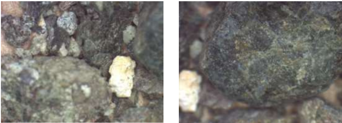
Figura 41.- Fotografías de perlita tomadas con el microscopio estereoscópico con una lente de 4X. Imágenes de elaboración propia.
