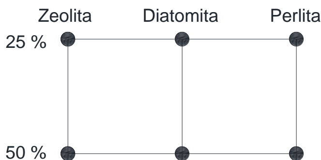
Figura 2.- Esquema del experimento factorial aplicado en este trabajo. Imagen de realización propia.
