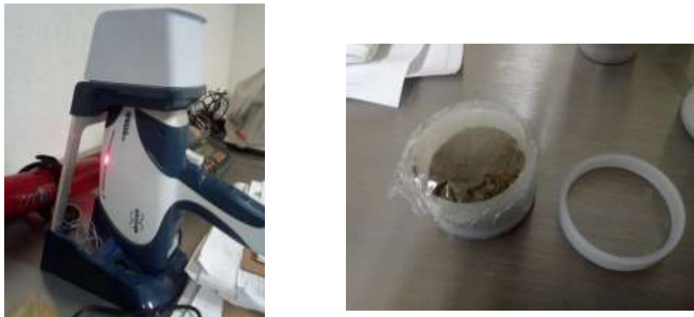
Figura 57.- Proceso para la prueba de fluorescencia de Rayos X. Fotografías d elaboración propia.
