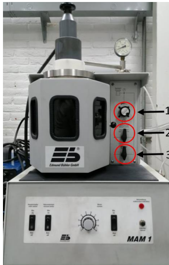
Figura 10. Horno de arco eléctrico. Señalamiento de perillas. Modelo: MAM 1, Marca: Edmund Bühler GmbH. Perilla 1: Activación de vacío, salida de aire o gases. Perilla 2: Entrada de Argón. Perilla 3: Entrada de aire.
