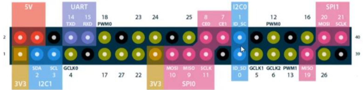
Figura 4.3. Distribución de pines GPIO de Raspberry Pi.
