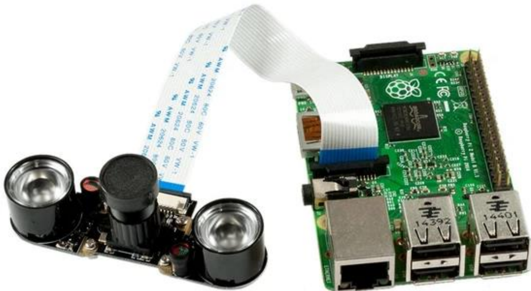
Figura 4.12. Cámara OV5647 con leds infrarrojos conectada a la Raspberry Pi.
