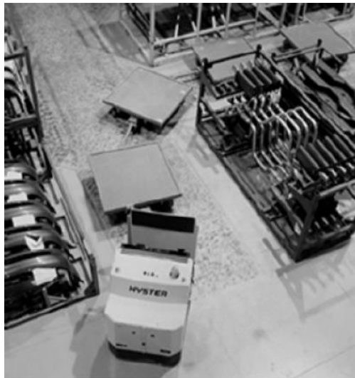
Figura 1.3. Sistema de transporte de Material Automatizado (AMTS por sus siglas en inglés).
