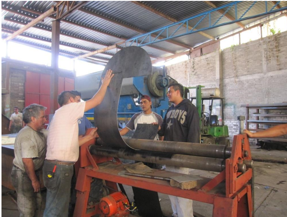
Fig. 79 Aquí una de las secciones de la pieza en metal ya cortada a la medida definitiva y en proceso de rolado en un taller especializado. Obsérvese el tipo de maquinaria requerida y manejo técnico. Hacer este procedimiento sólo manualmente sería difícil, ya que implicaría mucho tiempo y no se lograría obtener el mismo acabado en el modelado de las formas.
