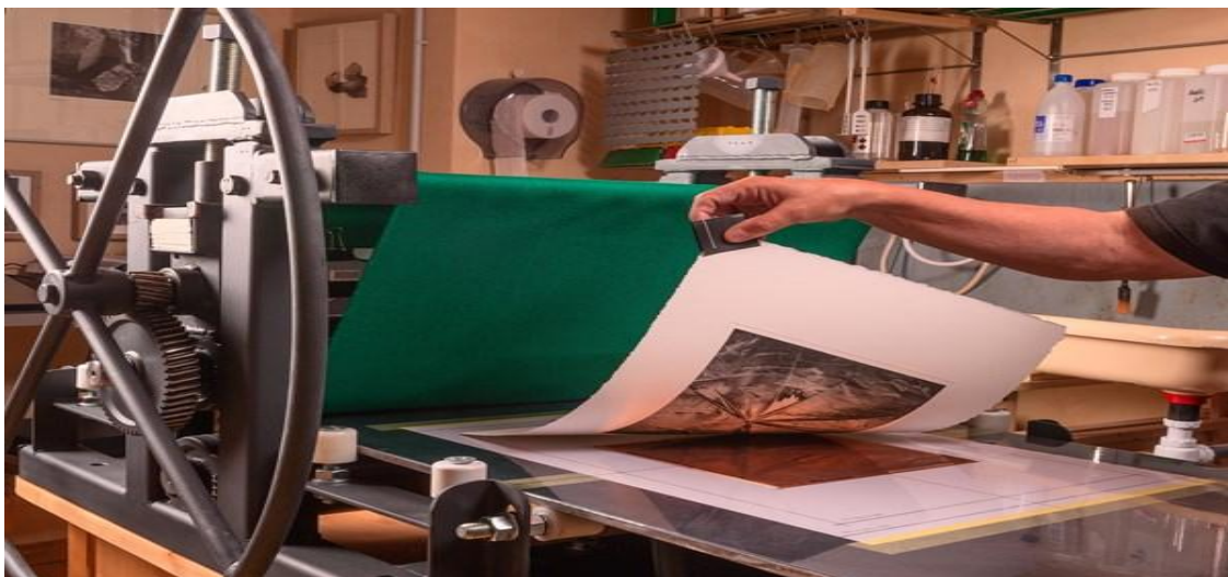
Fig. 64 Aguafuerte: impresión, utilizando una máquina llamada tórculo mecánico que actúa generando altas presiones entre la placa y el papel, logrando la transferencia de la imagen al papel.
