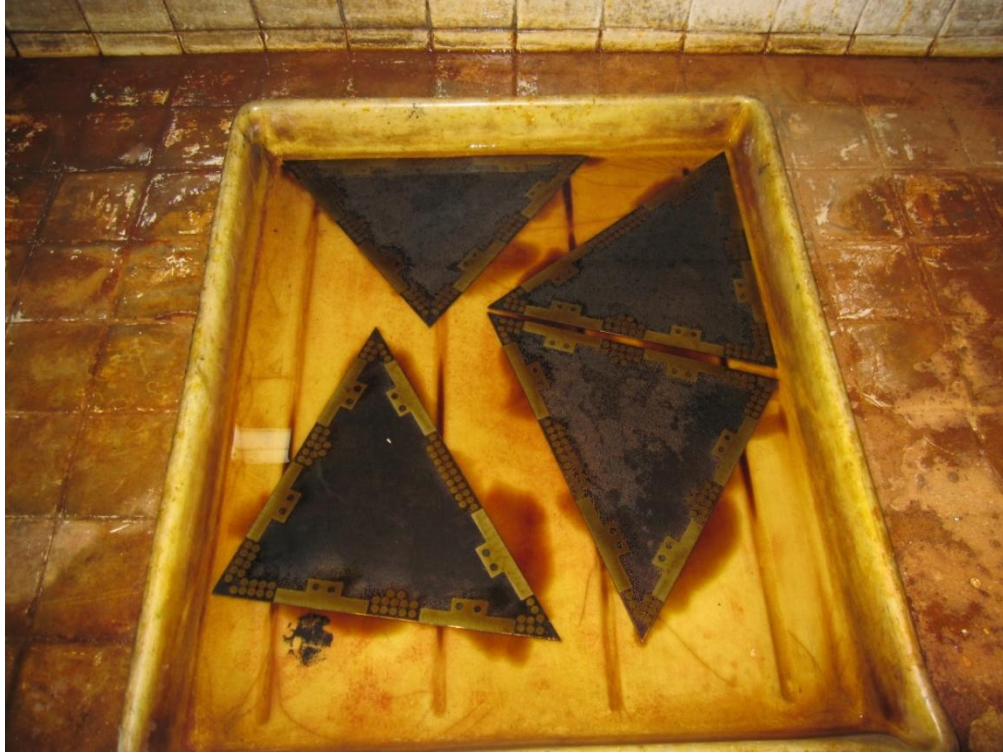
Fig. 75 Planchas de hierro sumergidas en una solución de ácido nítrico diluido en una proporción 1:8 que comienzan a mostrar el efecto del ácido. Se observan formas nebulosas color marrón en los bordes, junto a las zonas claras-desprotegidas, esto es el hierro que se está desprendiendo por la acción del ácido. Este procedimiento se realizó con la asesoría del Mtro. Alejandro Pérez Cruz en su taller de la Academia de San Carlos.
