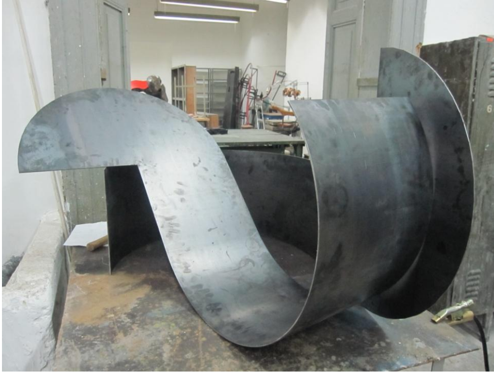
Fig. 80 Piezas de metal ya cortadas y modeladas, proporción 8/1. El tamaño aumenta en ocho tantos, el acabado es resultado del proceso técnico de rolado aplicado para las partes curvas.
