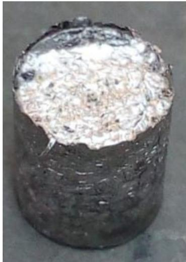
Figura 3.15: Consolidado por SPS ( $T = 350\text{ }^{\circ}\text{C}$ ).
