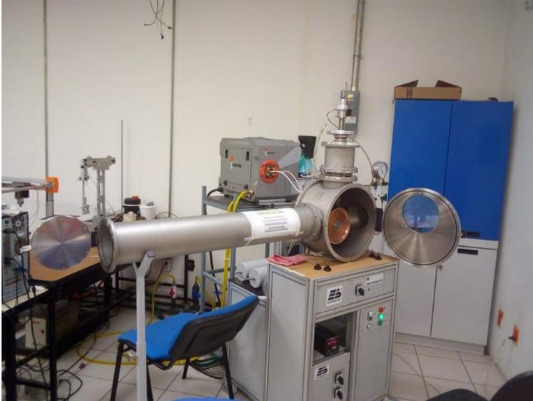
Figura 3.1: Melt Spinner marca Edmund Bühler del Laboratorio del Tratamientos Térmicos del IPICYT.
