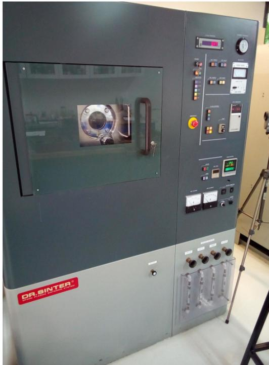
Figura 3.14: Equipo para consolidado por arco eléctrico Dr. Sinter del CIITEC.
