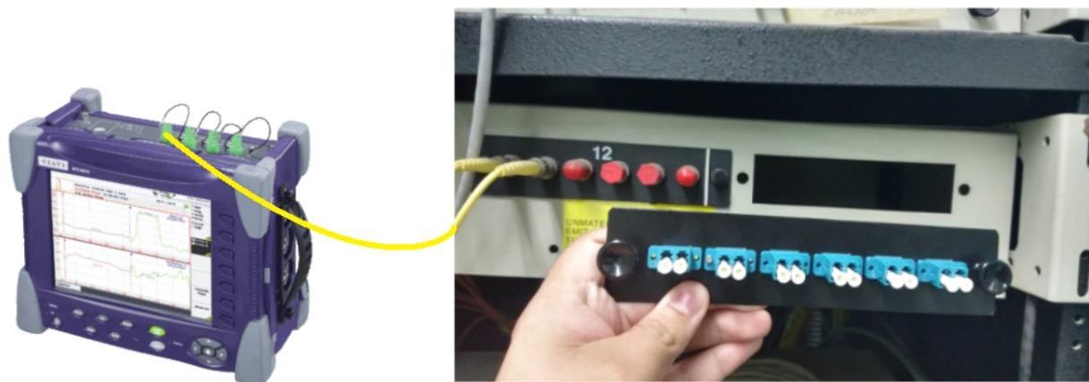
*Figura 2.8. Conexión del OTDR en un enlace que va del sitio 1 al sitio 12, aunque la conexión será la misma para cualquier enlace de fibra óptica.*
