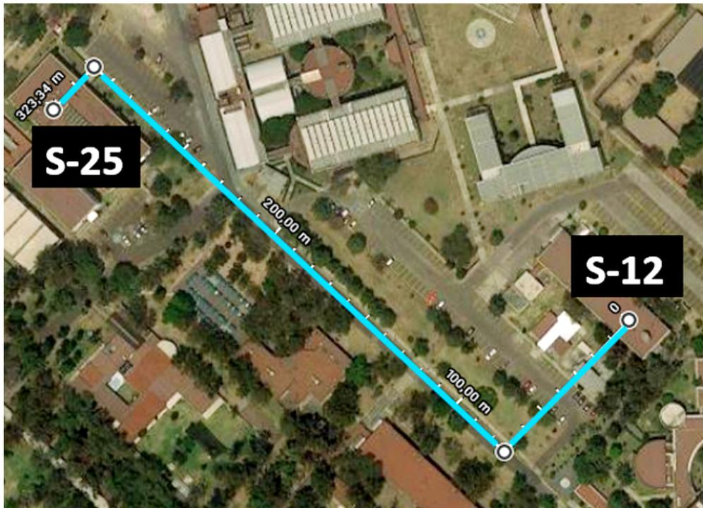
Figura 2.5. Imagen aérea del enlace que va del sitio 12 al 25, longitud de 323.34 m. [26]
