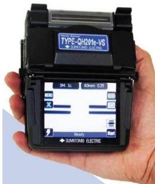
*Figura 1.14. Empalmadora de fusión de bolsillo. [19]*
