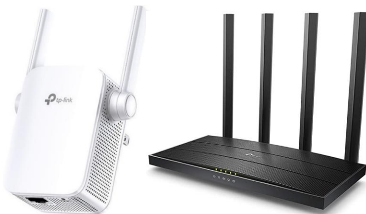
Figura 35. Infraestructura de usuario final, fabricante TP-Link. De izquierda a derecha: Repetidor de WiFi TL-WA855RE y Router Inalámbrico ROUTPL940.
