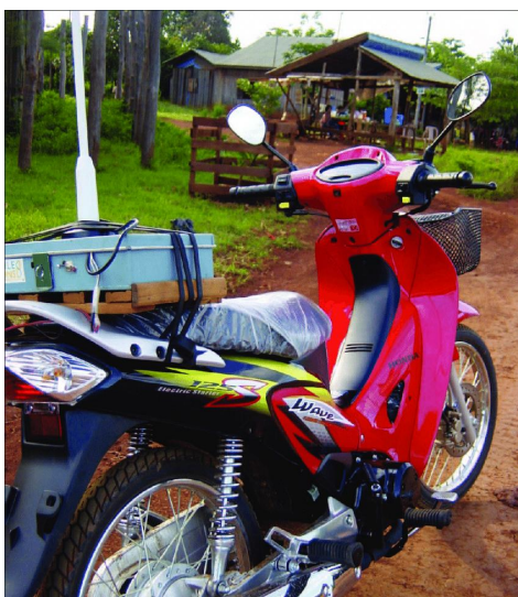
Figura 30. Motocicleta con una caja de WiFi de la red DakNet
