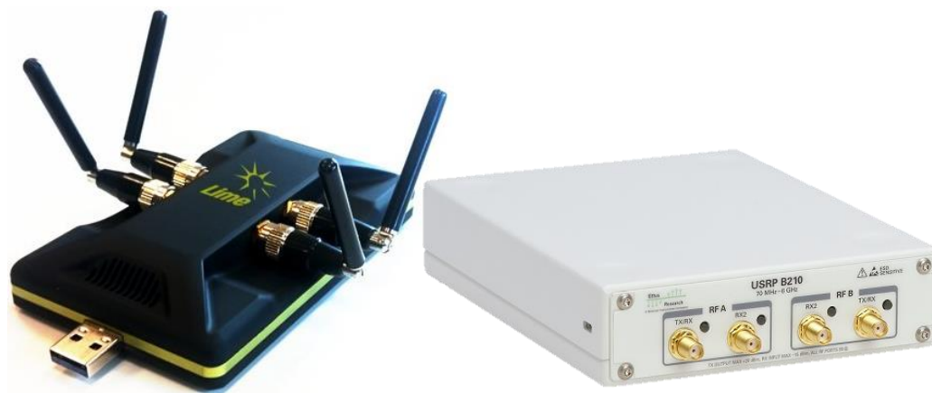
Figura 14. De izquierda a derecha: Dispositivo LimeSDR y USRP B210
