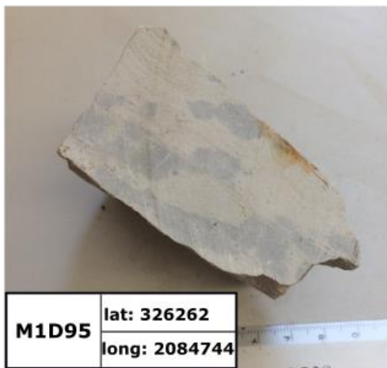
Figura 5.1.5 muestras de la zona de Nanchititla con textura afanítica
