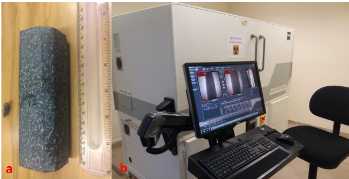
Figura 3.2.7 Microtomógrafo Xradia Versa 510; a) preparación de la muestra, b) Equipo de microtomografía para la obtención de imágenes en escala de grises.
