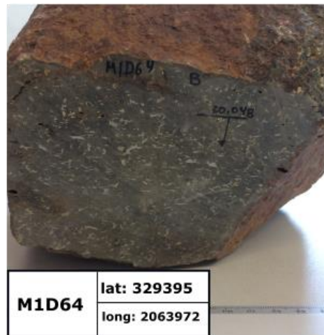
Figura 5.1.2 muestras de la zona de Nanchititla con textura porfídica
