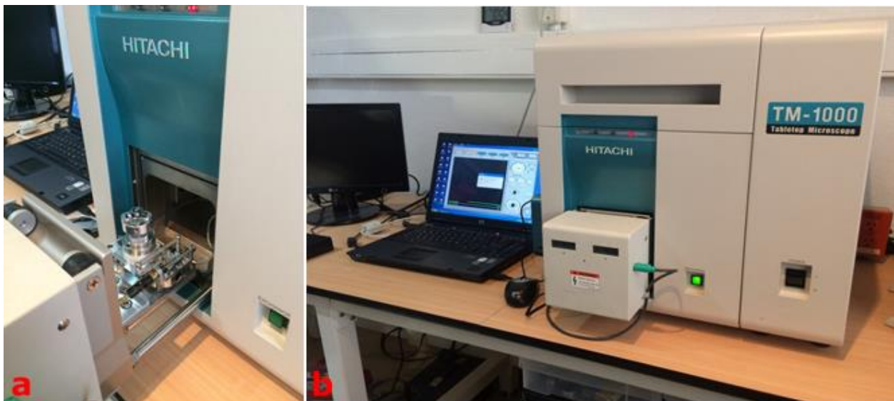
Figura 4.2.2 Equipo de Microscopía electrónica de barrido; a) Zona donde se introduce la muestra, b) Equipo para la obtención composicional elemental.
