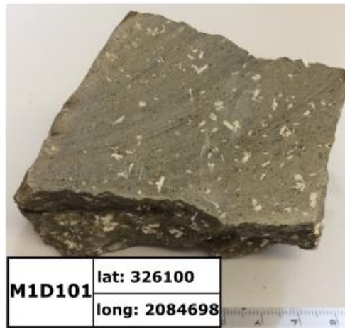
Figura 5.1.3 muestras de la zona de Nanchititla con textura porfídica
