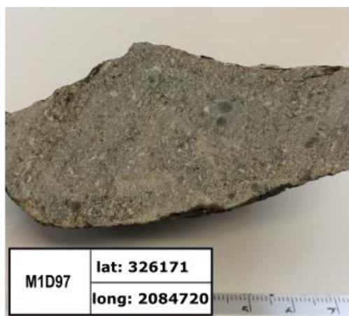
Figura 5.1.6 muestras de la zona de Nanchititla con textura afanítica
