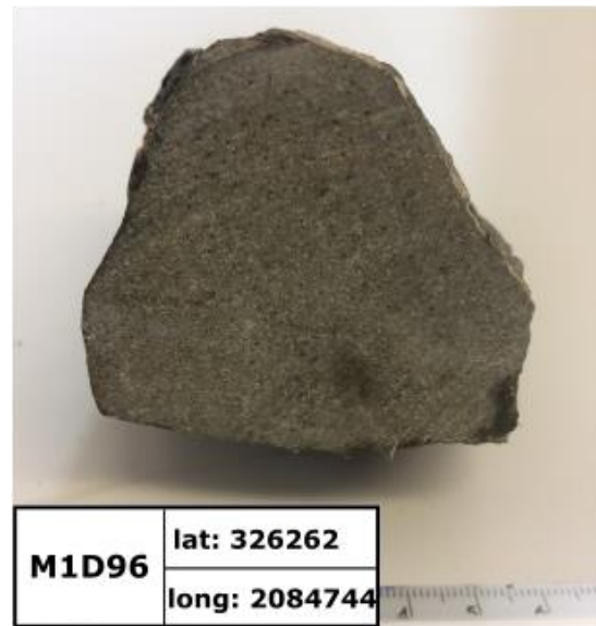
Figura 5.1.5 muestras de la zona de Nanchititla con textura afanítica
