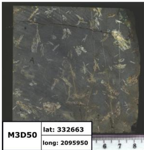
Figura 5.1.2 muestras de la zona de Nanchititla con textura porfídica
