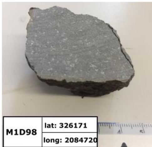
Figura 5.1.3 muestras de la zona de Nanchititla con textura porfídica
