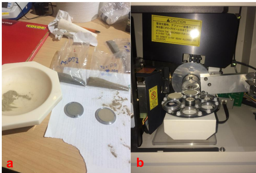
Figura 3.2.4 Equipo de difracción de rayos X de polvos (DRXP); a) preparación de la muestra, b) Zona donde se introduce la muestra, para la obtención de minerales primarios.
