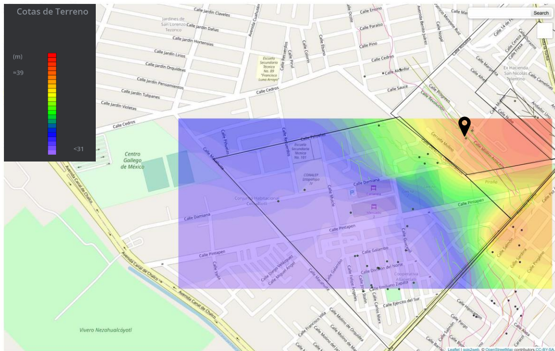
Figura 58. Capas de exposición (profundidad del basamento y cotas de terreno), donde se muestra la alta exposición que tiene la Unidad Habitacional Molino 25 al agrietamiento (Con permiso de impresión de García et al., 2019).
