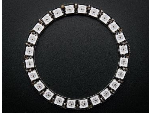
Figura 21. Anillo de 24 LEDs RGB, de marca Adafruit.
