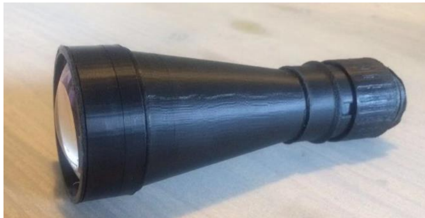
Figura 19. Fotografía de todas las piezas ensambladas con la lente oftalmoscópica.
