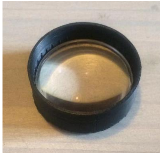
Figura 20. Lente oftalmoscópica de 20 dioptrías empleada para la experimentación del prototipo.
