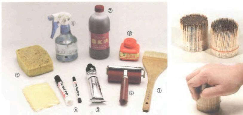
Figura 16. Izquierda: (2013) Materiales originales del Mokurito: 1- brocha de pelo de conejo; 2- rodillo de goma pequeño; 3- tinta tipográfica; 4- marcador *sakura* delgado y grueso; 5- esponja litográfica; 6- aspersor de agua; 7- solución SK, que consta de goma arábiga con ácido tánico; 8- tinta de color rojo. Derecha: baren de palillos de dientes. Japón.
