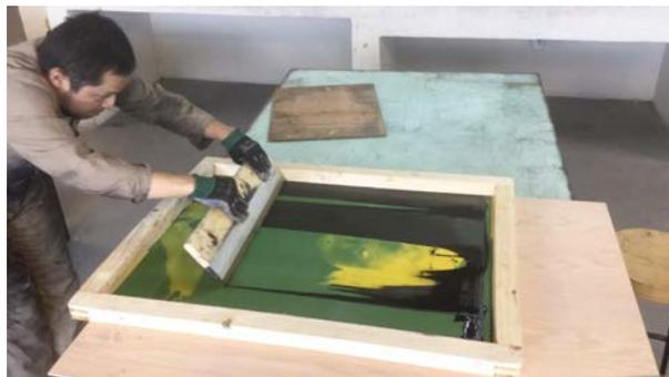
Figura 67. Ruíz Martínez, G. (2019). Aplicación de transferencia con tinta tipográfica usando métodos de serigrafía. [Fotografía]
