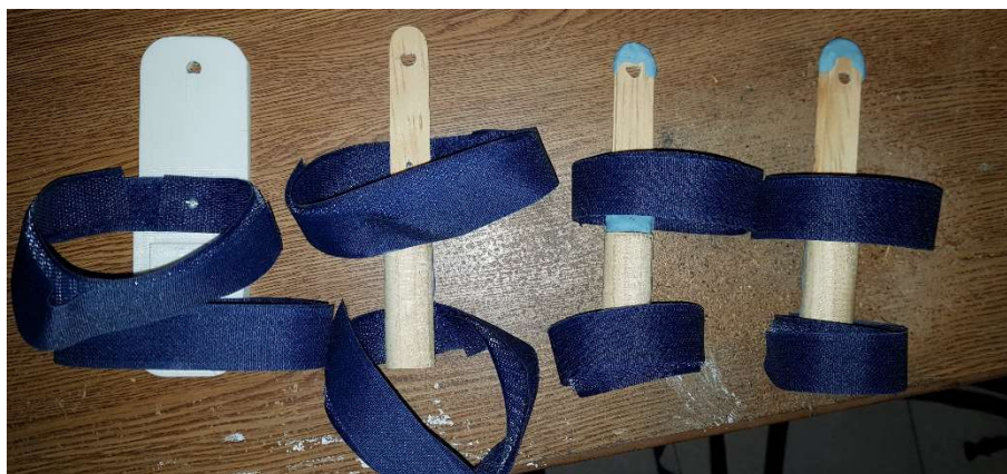
Ilustración 49. Piezas complementarias para los encoders, estas se ajustan a los ejes de los mismos y se adhieren a la parte opuesta del miembro con los trozos de velcro.
