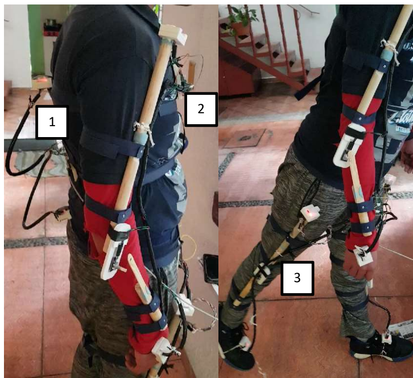
Ilustración 56. Vista lateral de la colocación de los sensores en la columna (1), el tren superior (2) y el tren inferior (3).
