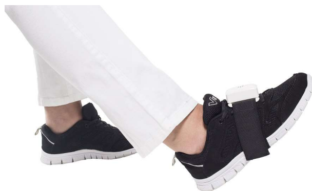
Ilustración 21. Sistema PABLO de extremidad inferior colocado en el dorso del pie, tomado de [52].
