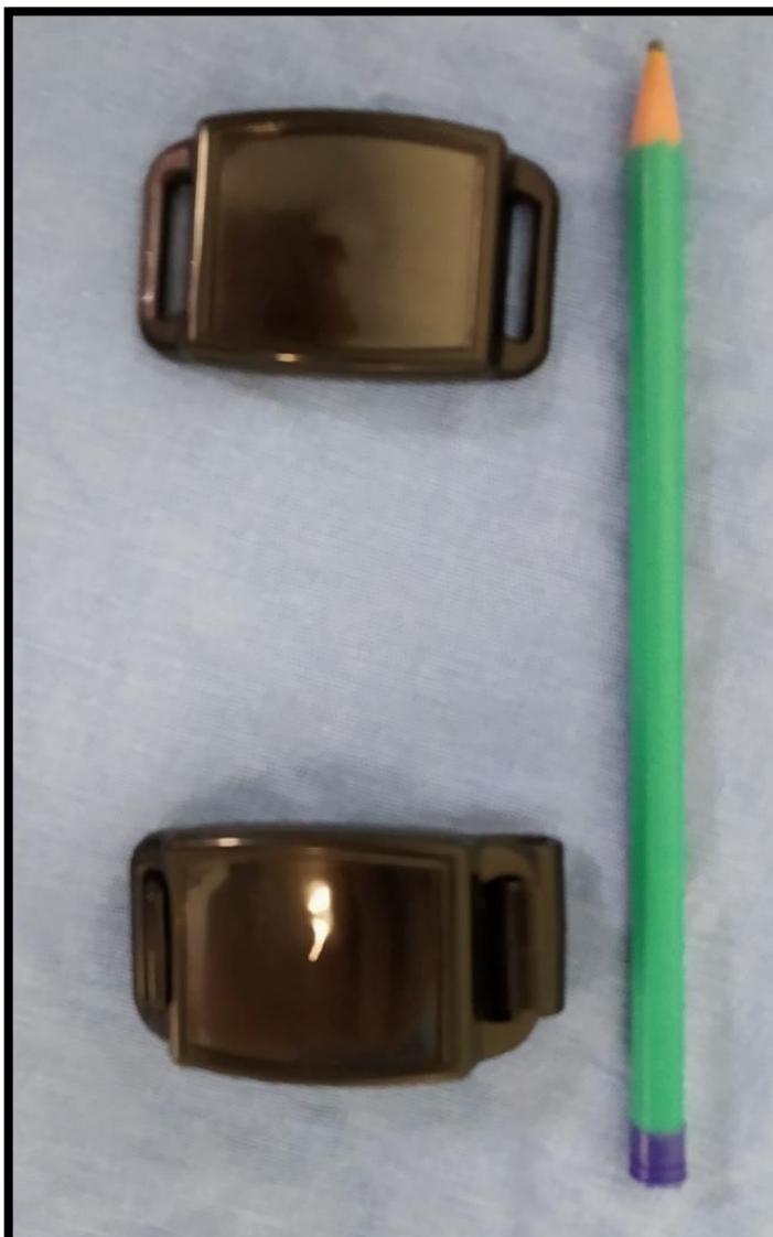
Figura 11. Imanes incluidos en el paquete del ENV, usados para desencadenar estímulo adicional en caso de crisis o aura de esta.
