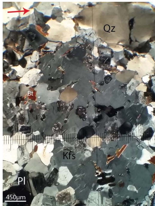
Figura 6.3-8 Fotomicrografías en nícoles cruzados de una diatexita, donde se observa un armazón de feldespato alcalino con textura pertítica e inclusiones de plagioclasa euédrica, biotitas subédricas y cuarzo redondeado.
