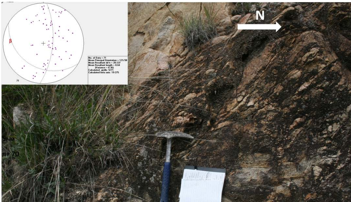
Figura 5.2-2 Imagen en campo de la foliación en un gneis migmatítico de la zona sur de la Migmatita Magdalena. En la parte inferior izquierda se presenta el estereograma de los polos de los planos de foliación.
