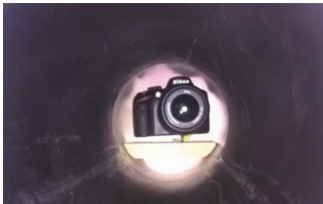
Fig. 2.06. Dispositivo de medición, video cámara dentro de tubo de PVC como pozo exploratorio. Elaboración del equipo.
