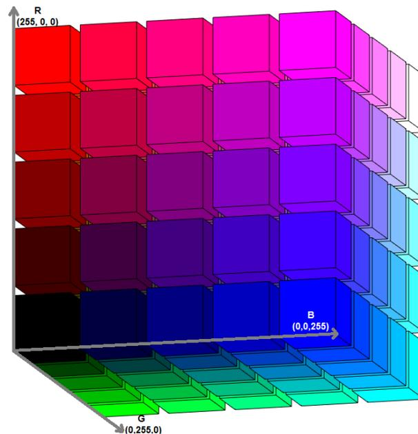
Figura 4. Cubo RGB con coordenadas. Generado en MatLab.
