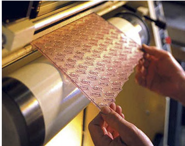
Figura 8 Polímero de impresión flexográfico Fuente: Álvarez, n. d.
