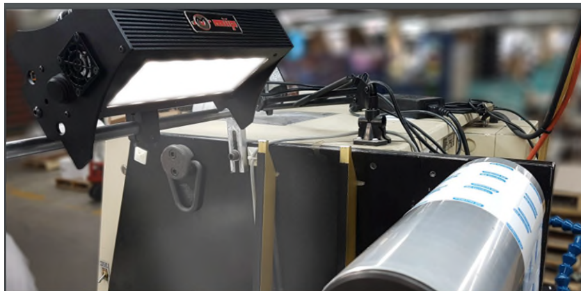
Figura 34 Lámpara estroboscópica Fuente: MIIP, n. d.
