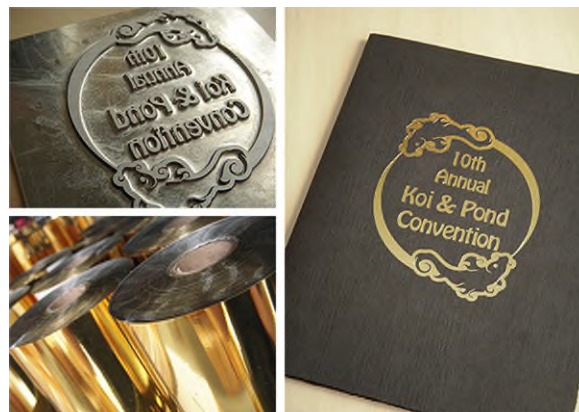
Figura 15 Ejemplos y material para hot stamping Fuente: Hot Stamping, n. d.
