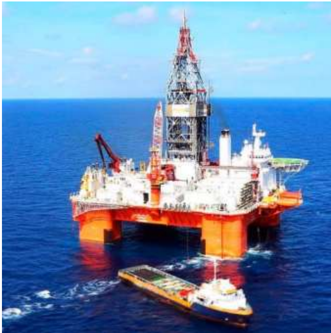
Figura 4.22 Plataforma semi - sumergible de posicionamiento dinámico para perforar pozos en AP y UAP o DP Semi - Submersible Drilling Platform.
