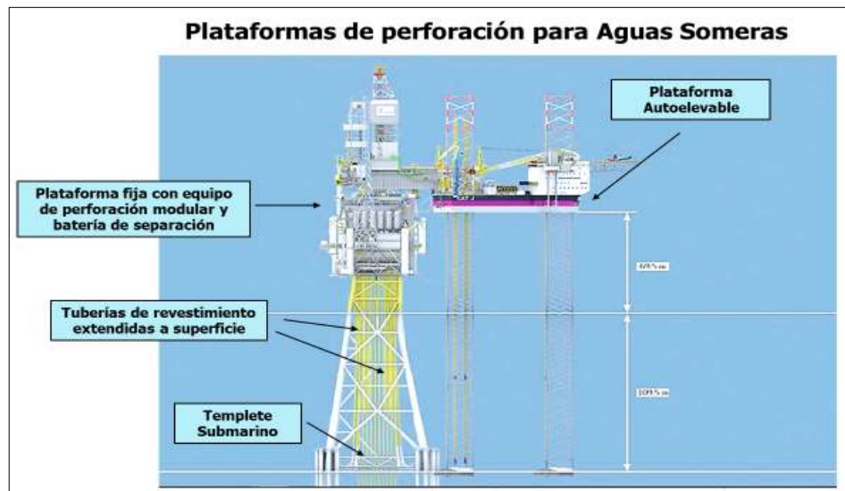
Figura 4.32 Plataforma fija operada con PAE acoderada para continuar perforando pozos
