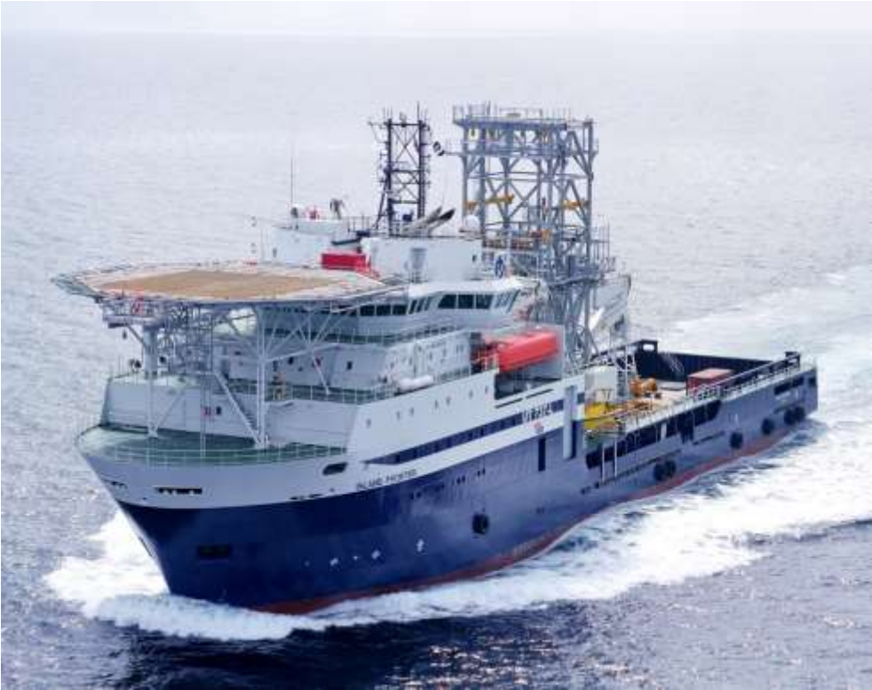
Figura XII Ejemplo de embarcación multi propósito para intervenciones a pozos.
