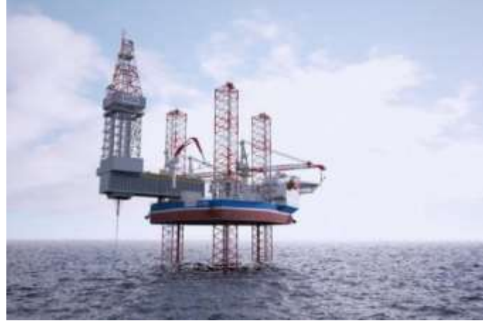
Figura 4.27 Plataforma de perforación tipo Jack up con cabezales tipo Mudline Suspension System.
