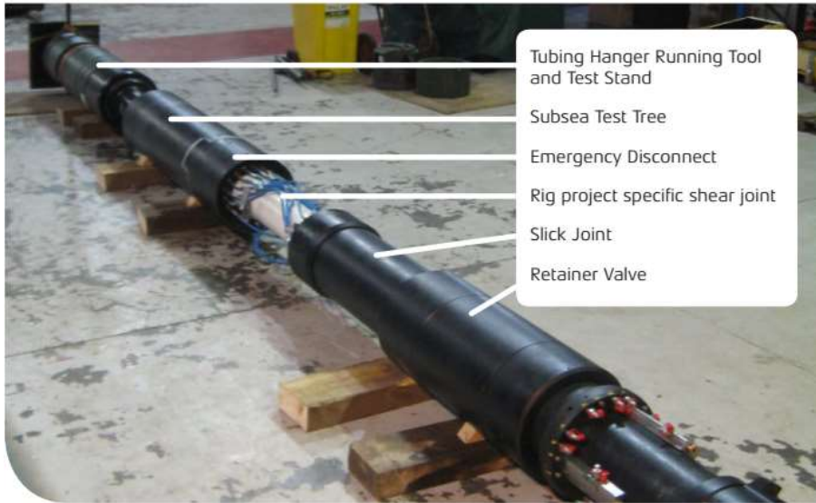
Figura V SCLSS sobre la cubierta de un MODU
