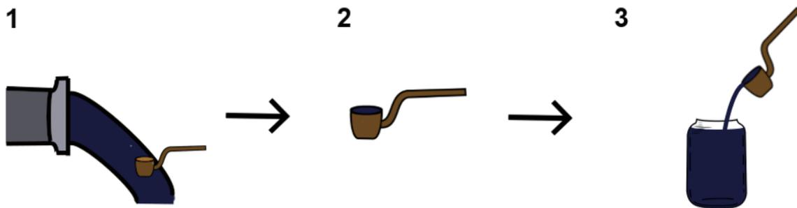
Fig. 9. Procedimiento para muestreo en aguas residuales en forma de chorro
