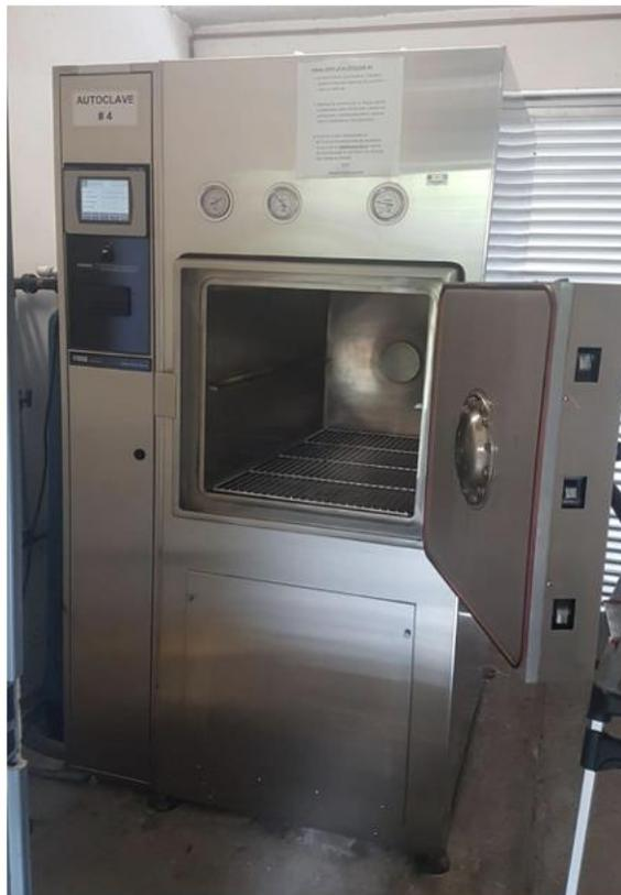
Fig. 5. Autoclave para esterilización.
