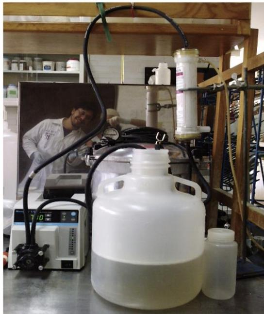
Fig. 11. Sistema de ultrafiltración ensamblado en el laboratorio
