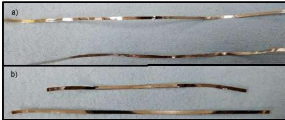
**Fig. 4.2** Cintas obtenidas de a) 25 m/s y b) 8 m/s
