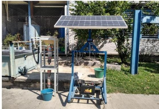
Ilustración 1. Sistema de electrocoagulación
