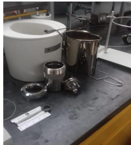
FIG.5 Bomba calorimétrica desmontada
