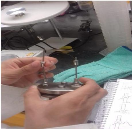
FIG. 1 Colocación del alambre Ni-Cr
