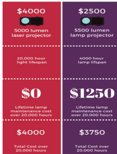
Ilustración 4: La vida de un proyector láser ronda de los 20 mil a 30 mil horas, aunque el costo inicial es más elevado en comparación con un proyector tradicional, ofrece menor costo en el mantenimiento y un mayor tiempo de vida útil.
