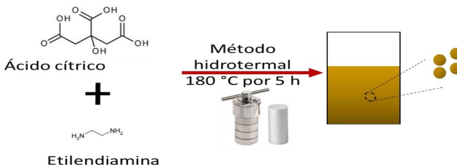
**Figura 4.6.** Esquema de preparación de puntos cuánticos de carbono.
