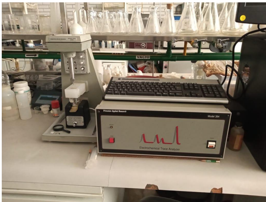
Figura 5. Equipo usado para la determinación de los metales pesados. (Electrochemical trace analyzer, Model 303A SMDE, PRINCETON APPLIED RESEARCH).
