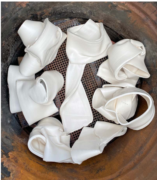
Imagen 30. Acomodo de las piezas antes de la última quema. Fuente: Elaboración propia.
