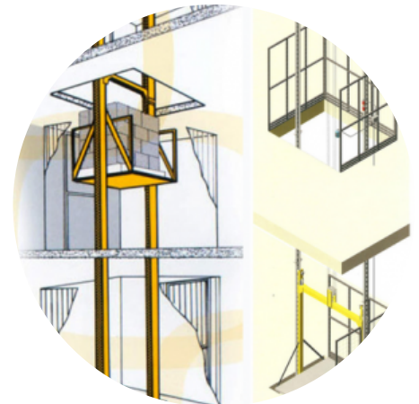
Monta cargas fijo a estructura [114]
