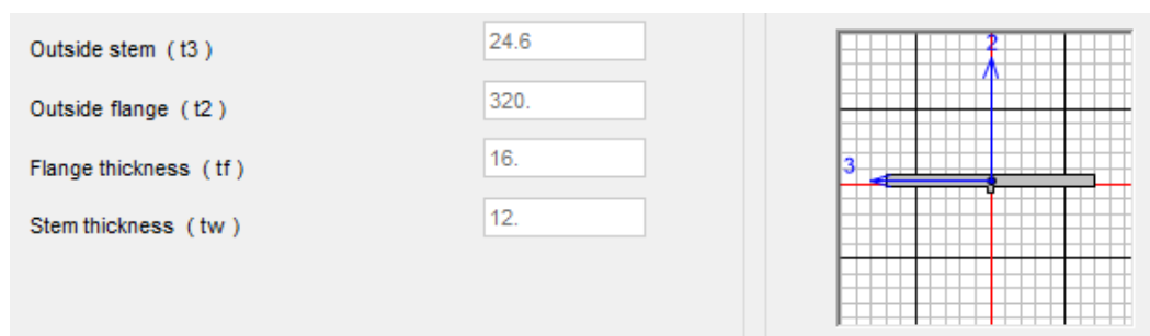
Figura 5.7. Corte transversal de dala-losa.
