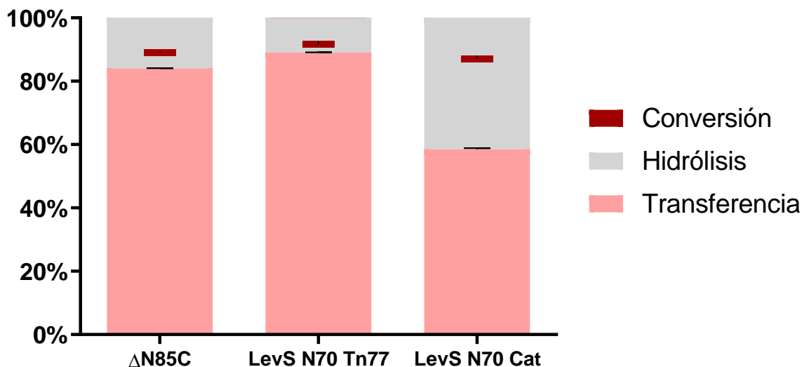
Figura 31. Relación H-T de las versiones truncadas. Porcentaje de conversión: ΔN85C (89 %), LevS N70 Tn77 (91.7 %) y LevS N70 Cat (87 %). En las barras grises y rosas se muestra la reacción de hidrólisis y transferencia, respectivamente; en rojo se muestra el porcentaje de conversión de sustrato a través del tiempo de reacción.
