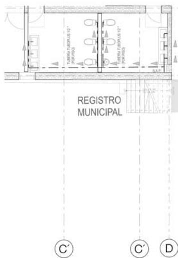
DET-01 INSTALACIÓN HIDRAULICA EN PLANTA BAJA / ESC. 1:50
