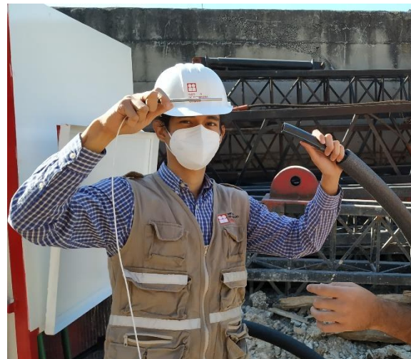
(b) Medición de la temperatura media del suelo con el sensor Pt 100
