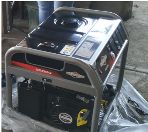
Figura 3.14. Generador eléctrico S500.
