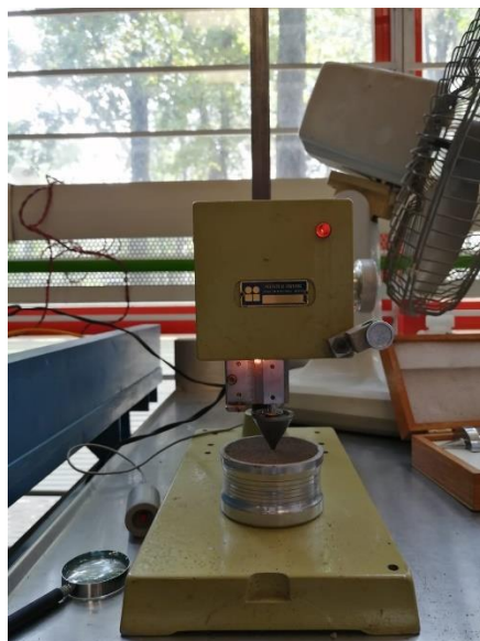
Figura 4.19. Límite líquido usando el cono sueco.
