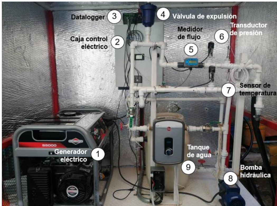
Figura 3.17. Primer diseño del equipo TRT-IIUNAM (2020).
