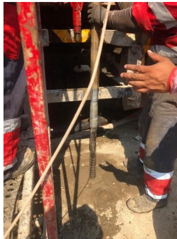
(d) Inmersión de la sonda de Ficómetro en el barreno
