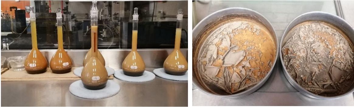
Figura 4.17. Determinación de la densidad de sólidos.
