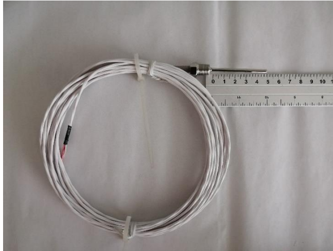
Figura 3.9. Sensores de temperatura Pt 100 colocados en el equipo TRT-IIUNAM.
