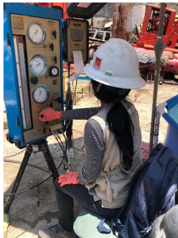
(f) Ejecución de la prueba con Presiómetro Menard
