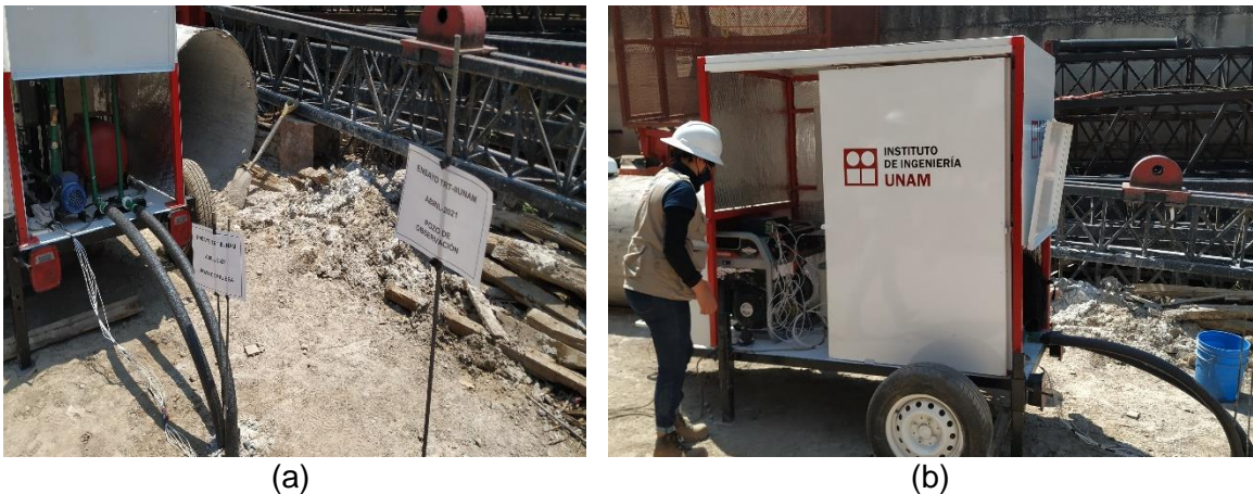
Figura 4.31. a) Conexión de las tuberías del pozo de prueba al equipo TRT-IIUNAM; b) Revisión de los sensores dentro del equipo TRT-IIUNAM.
