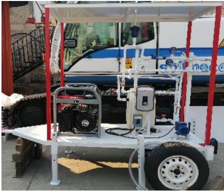
(a) Montaje del circuito interno de funcionamiento
