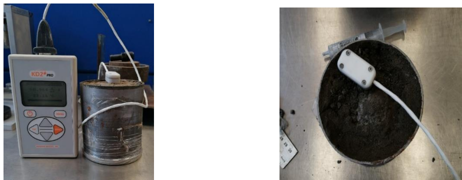
Figura 4.20. Medición de la conductividad térmica con el Método de la Aguja Térmica (equipo KD2 Pro del IIUNAM).
