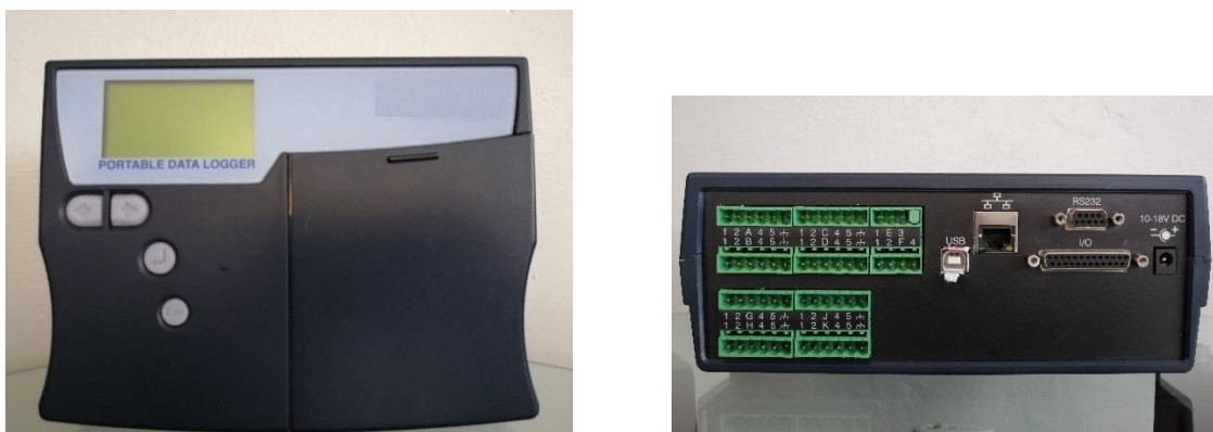
Figura 3.12. Equipo de adquisición de datos utilizado durante el primer ensayo TRT.
