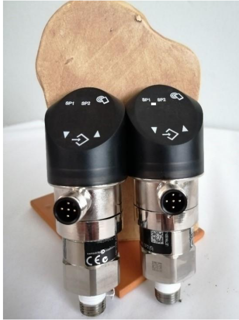
Figura 3.11. Transductores de presión colocados en el equipo TRT-IIUNAM.
