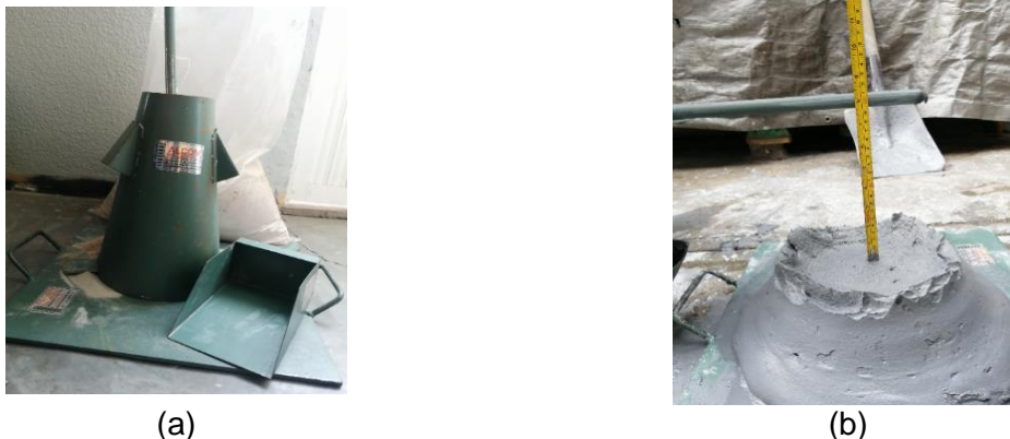
Figura B.1. (a) Cono de Abrams, (b) Prueba de revenimiento en la mezcla CM3.
