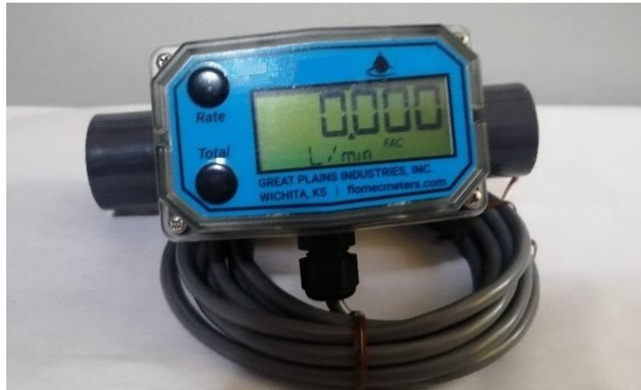
Figura 3.10. Medidor de flujo tipo turbina instalado en el equipo TRT-IIUNAM.
