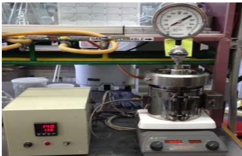
Figura 5.2. Síntesis hidrotérmica de los nanotubos de trititanato sódico.
