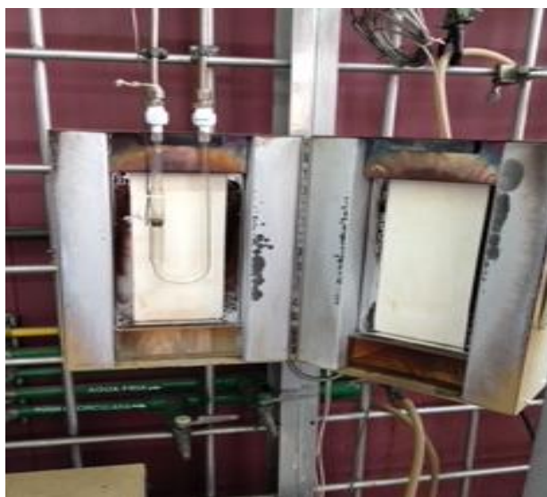
Figura 5.11. Activación de los catalizadores en estado oxidado.
