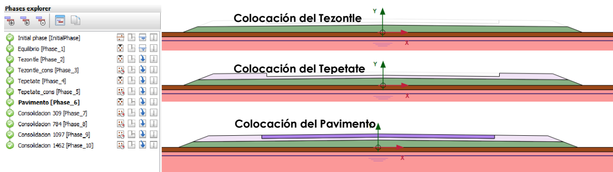
Figura 5.15 Proceso constructivo en PLAXIS
