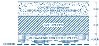
PAD DE CONCRETO ESC. 1:12.5
