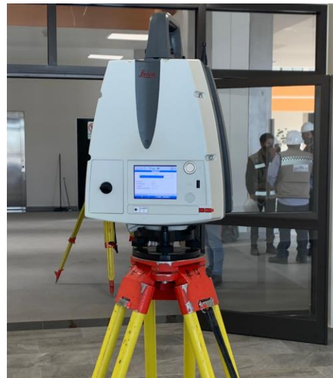
Escáner de nube de puntos 3D funcionando y escaneando a color. | Autor: César Alejandro Chavira Ramos.
