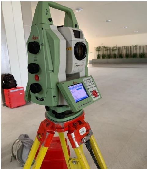
Estación total para georeferenciar el escáner de nube de puntos 3D. | Autor: César Alejandro Chavira Ramos.
