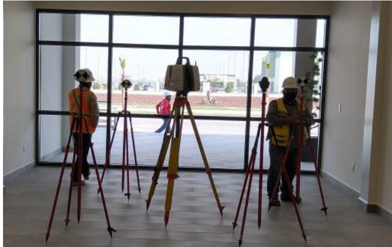
Cuadrilla de topógrafos colocando aparatos para sacar una nube de puntos 3D. | Autor: César Alejandro Chavira Ramos.
