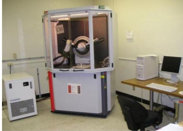
Figura 17. Difractómetro de rayos x, Bruker D8-Advanced.
