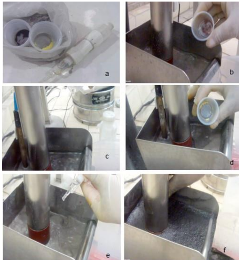
Figura 27. Flotación selectiva de cobre: a) Adición de reactivos, b) Adición de colector y depresor, c) Ajuste del pH, d) Adición de sulfato de cobre, e) Adición de espumante y f) Recolección de concentrado.
