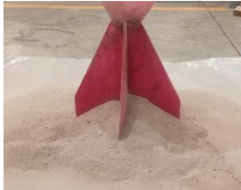
Figura 9. Cuarteo del mineral
