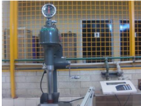
Figura 25. Celda de flotación Denver y pH-metro Oakton.
