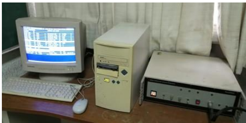
Figura 21. Equipo de laboratorio para VC: Ordenador, potenciostato Versastat I
