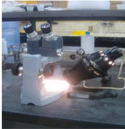
Figura 16. Microscopio American Optical para determinar tamaño de liberación.
