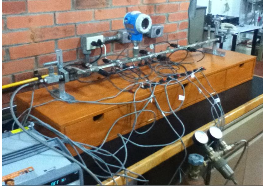
Figura F-4. 2 Banco de calibración con los sensores montados, junto con el tanque de nitrógeno y el adquisidor de datos.
