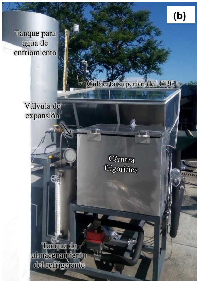
Figura 3.1. Diferentes vistas del Refrigerador solar intermitente (a) lateral, (b) frontal y (c) superior.
