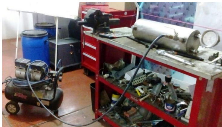
Figura F-1.2. Prueba neumática del tanque de almacenamiento, con aire comprimido.
