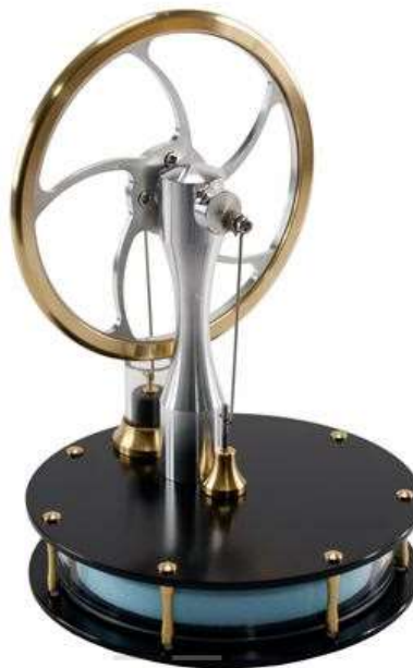
Figura 1.8 Del lado superior izquierdo se encuentra una configuración genérica de un motor tipo gamma (Jacek Kropiwnicki, Aleksandra Szewczyk, 2016), del lado superior derecho se encuentran los pasos de un ciclo Stirling en una configuración gamma (Mehrzaad Mojaver, 2019). La imagen en el fondo muestra un motor de configuración gama didáctico 25 .
