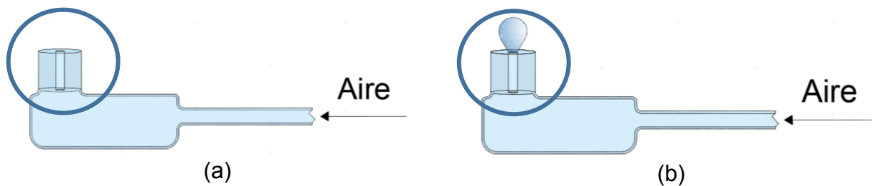
Figura 7.2 Capilar de vidrio utilizado dentro de la celda
