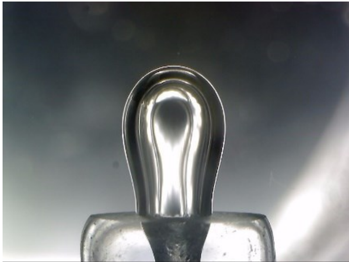
Figura 9.2 Imagen tomada en un ángulo diferente a 180^\circ , con la luz del laboratorio encendida, sin ajustes en la toma de imagen, sin filtro y capilar con orificio de salida tipo cono y solución de silicón en su superficie sin pulir
