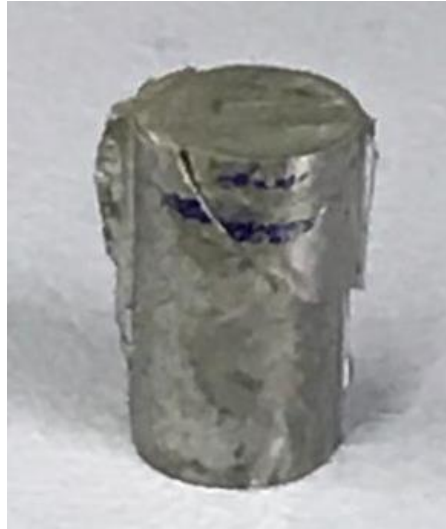
Figura 17. Pieza ensayada por compresión con fractura a 45°
