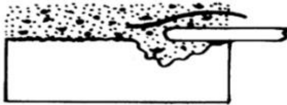
Figura 9. Esquema de corrosión por grietas (Crevice)
