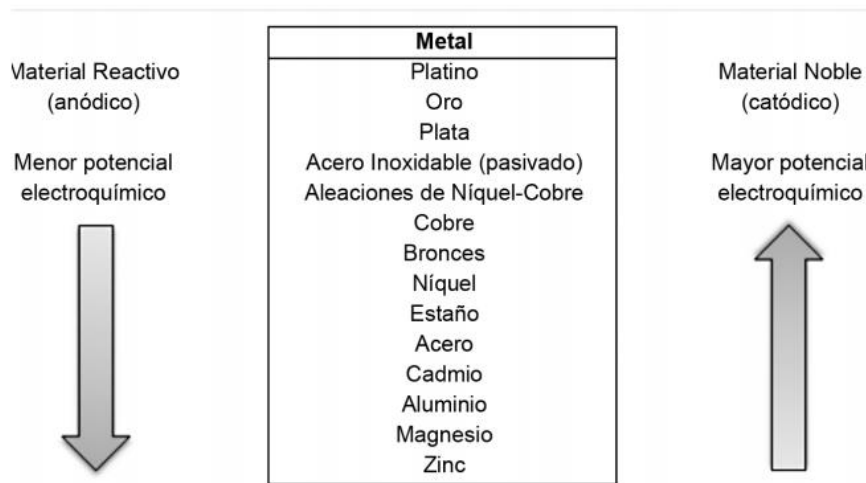
Figura 7. Serie galvánica para algunos metales y aleación comunes [10].
