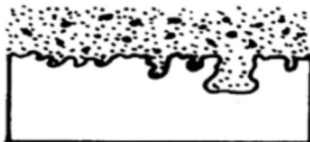
Figura 10. Esquema de corrosión por picadura (Pitting).
