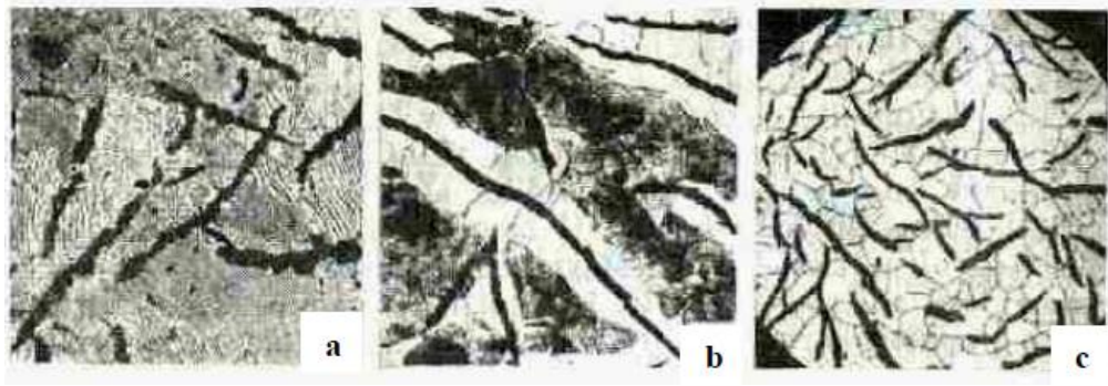
Figura 5. Microestructura de la fundición gris: a) fundición perlítica, tomada a 200 aumentos; b) fundición ferrito - perlítica, tomada a 100 aumentos; c) fundición ferrítica, tomada a 100 aumentos.
