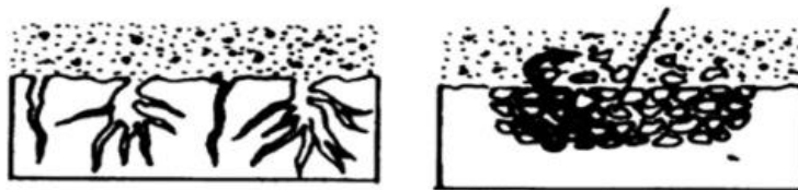
Figura 14. Corrosión por tensión (izquierda) y corrosión por fatiga (derecha)
