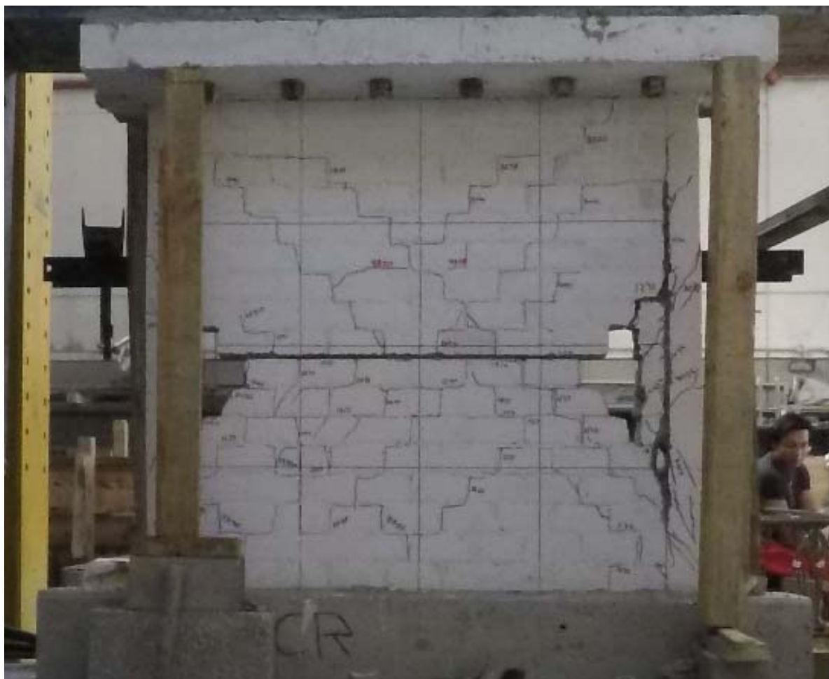
Figura 33. Modo de falla del modelo M1-cr
