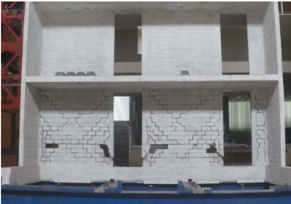
Figura 40. Modo de falla del modelo original
