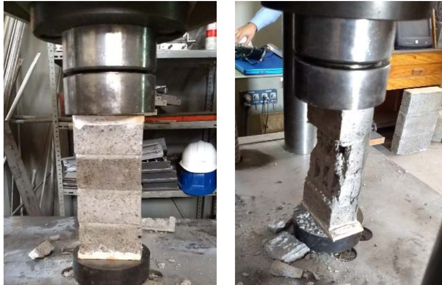
Figura 28. Ensayo de pilas
