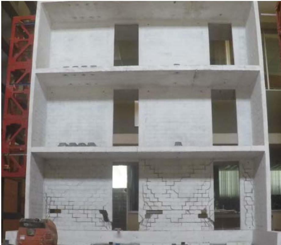
Figura 5. Modelo de edificio después del primer ensaye
