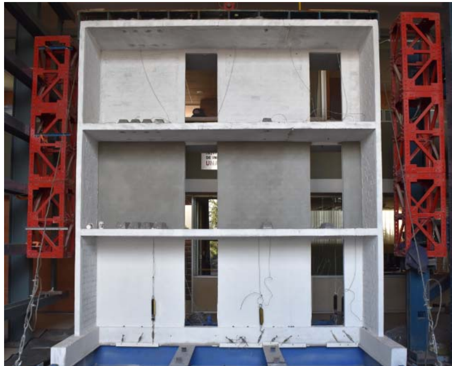
Figura 27. Segundo nivel rehabilitado del modelo del edificio
