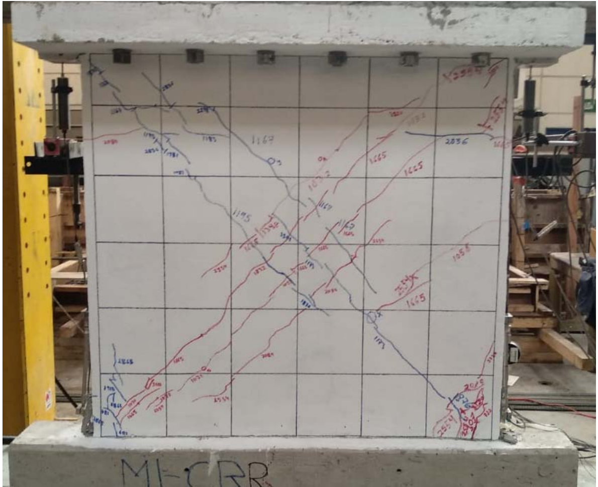
Figura 34. Modo de falla del modelo M1-crR
