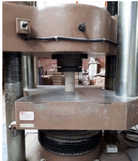
Figura 31. Ensaye de cilindros de concreto utilizados en cimentación y losas a compresión axial
