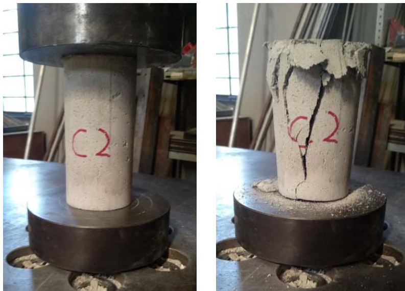
Figura 30. Ensayo de cilindros del mortero de rehabilitación a compresión axial
